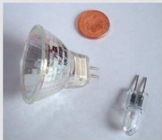
Halogenlampen der Typen GU4 mit MR11-Reflektor (links) und G4 (rechts); 12V, 20W
